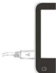
Nach dem Anschließen des Kabels wird auf dem Bildschirm des E88 Endomotors "CONNECTED!" angezeigt, was bedeutet, dass die Verbindung korrekt funktioniert.
